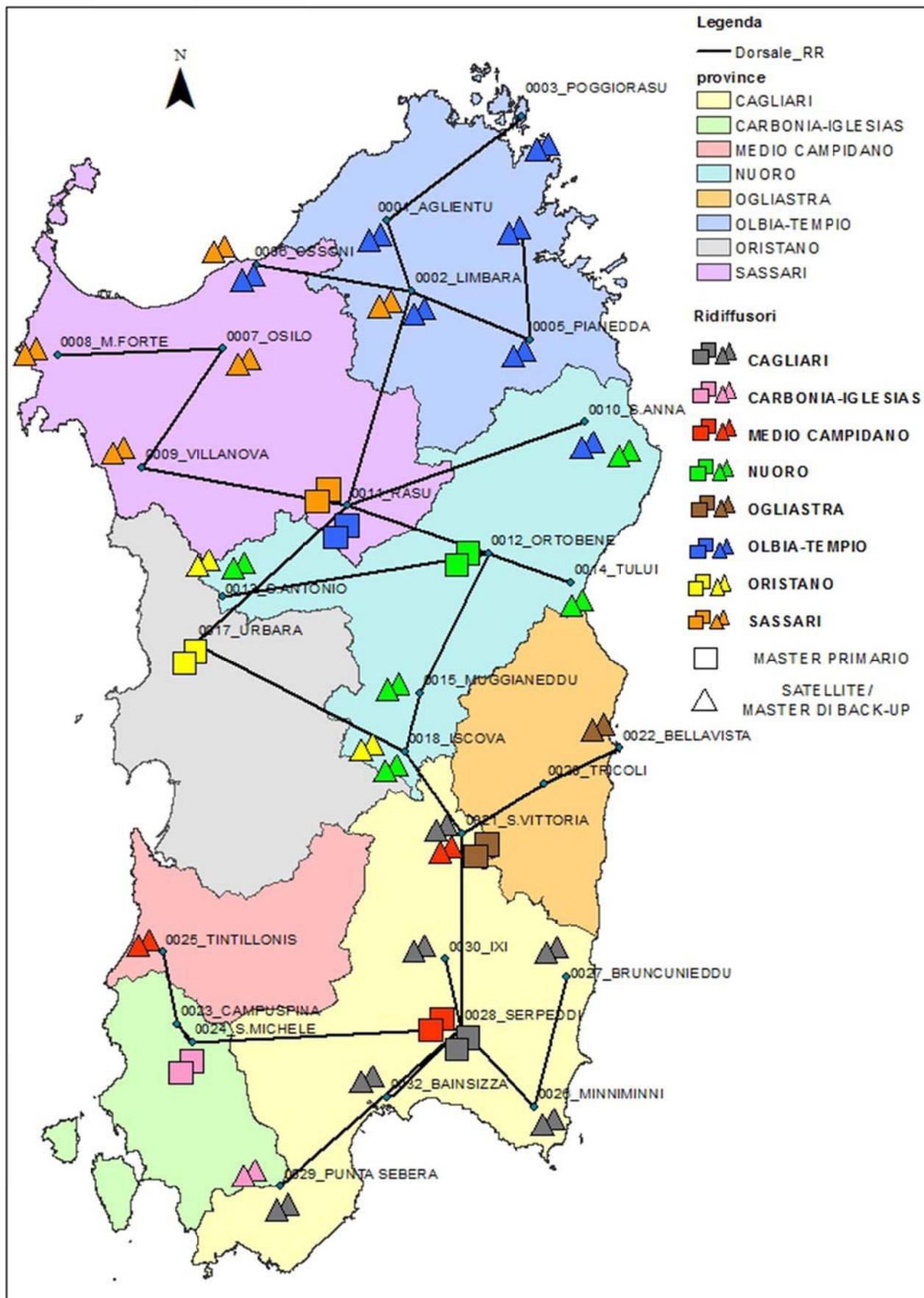
Struttura del sistema radio di protezione civile
